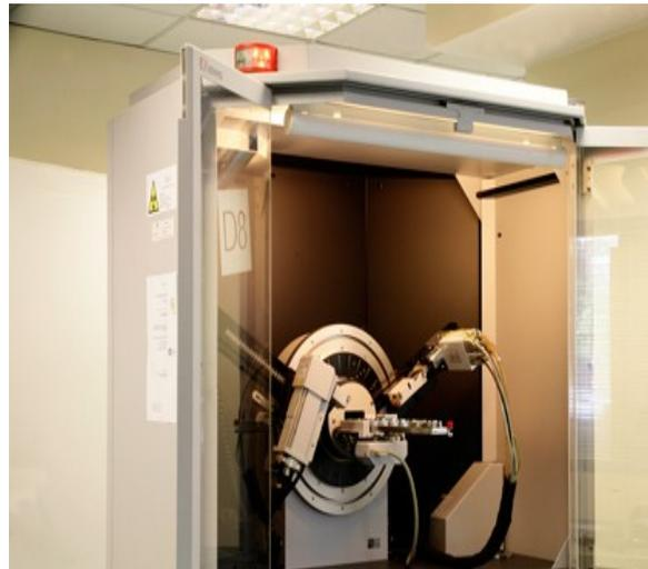
A la izquierda se muestra un esquema de un tubo de rayos X, a la derecha un equipo de difracción de Rayos X.
